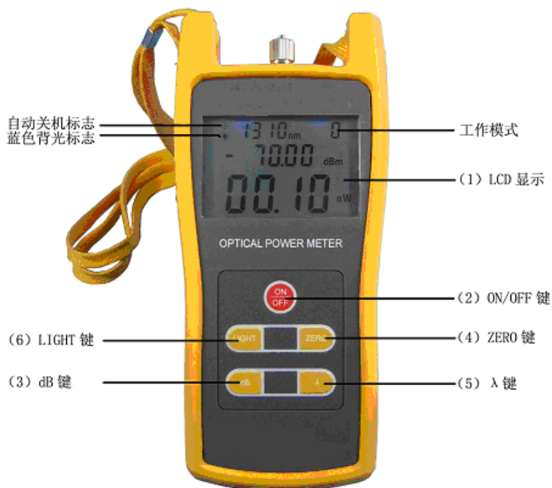
手持式光功率计控制面板图
